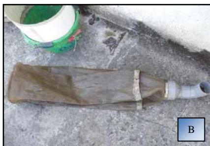
Figure 7 : Barrage de la Boule d'Or : A : passe à anguilles ; B : piège filet en sortie de passe à anguilles. Photo N Guillen.
