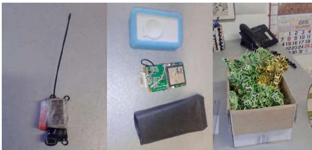
Figure 24 : Matériel de suivi individuel posé sur les anatidés pour un suivi par GPS (émetteur à gauche ou Cattrack au centre) et par CMR via les relectures de marques nasales (droite).
