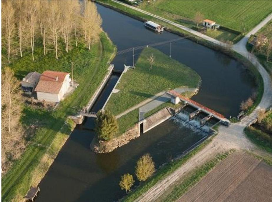
*Figure 8: vue aérienne de l'ouvrage du Marais Pin et de sa passe à poisson (PNRMP)*
